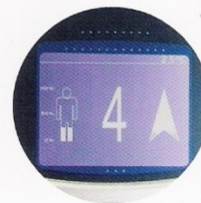
Indicateur de surcharge sonore et lumineux
